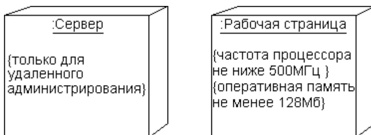
Рис. 69 Графическое изображение узла-экземпляра с дополнительной информацией в форме помеченного значения
