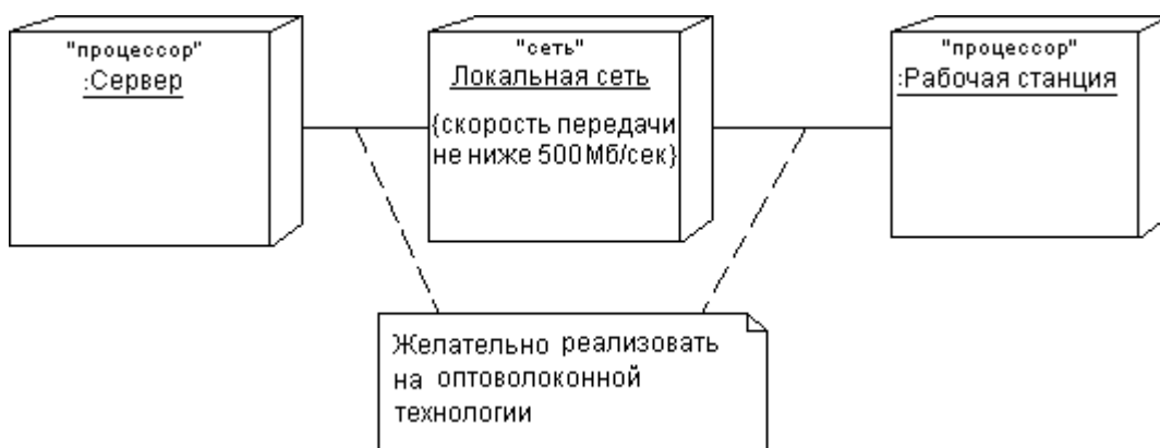
Рис. 70 Фрагмент диаграммы развертывания с соединениями между узлами
